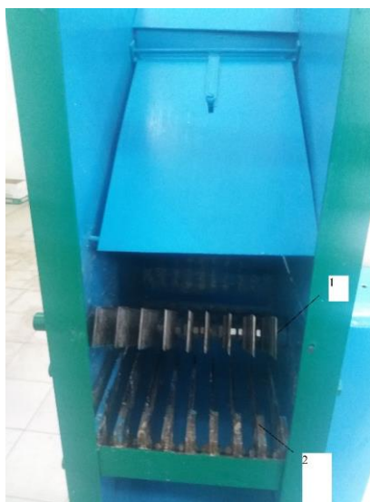
Рисунок 2 – Рабочие органы измельчителя корнеплодов: 1- ножи; 2 – противорезы.
