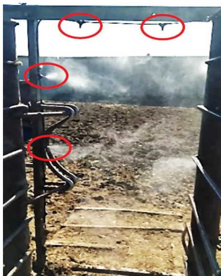
Сурет 3 – саптамалардың реттелетін орналасуы "Ауыл шаруашылығы жануарларын өңдеуге арналған қондырғыда"
