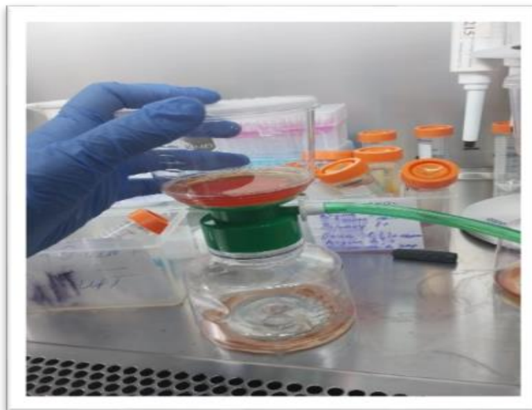
Рисунок 5 – Фильтрация образцов стандартной сыворотки через мембранный фильтр с размером пор 0,44 мкм
